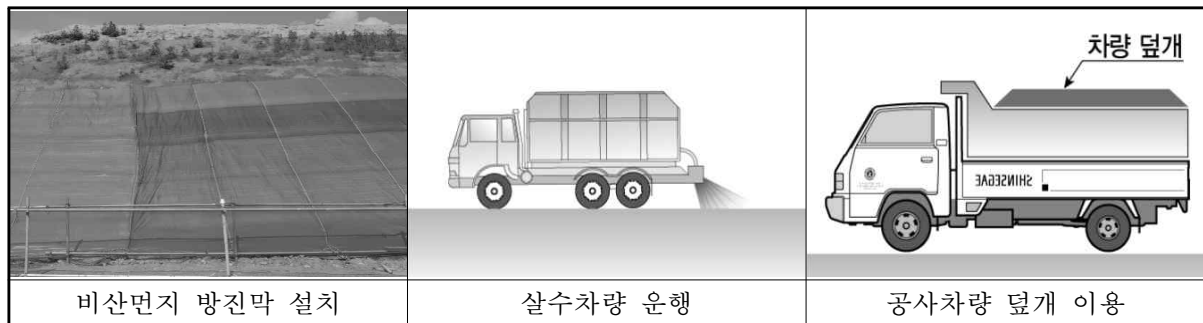
(그림 7.1.1-33) 비산먼지 발생에 대한 저감방안(예시)
